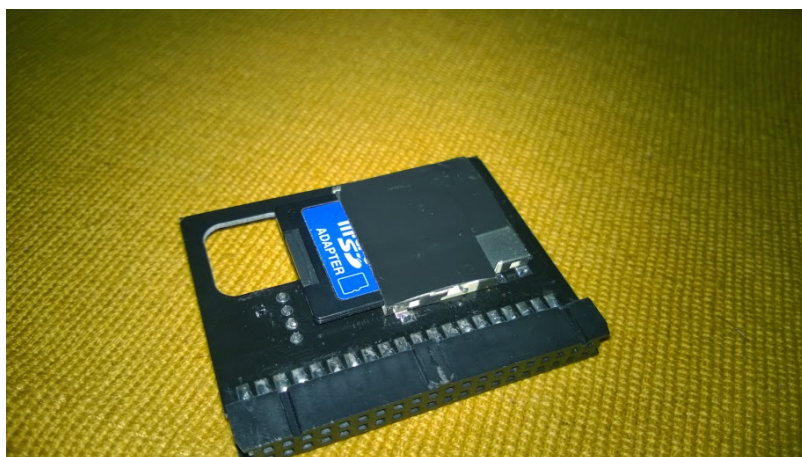
Fita isolante protegendo a parte metálica do adaptador SD.
